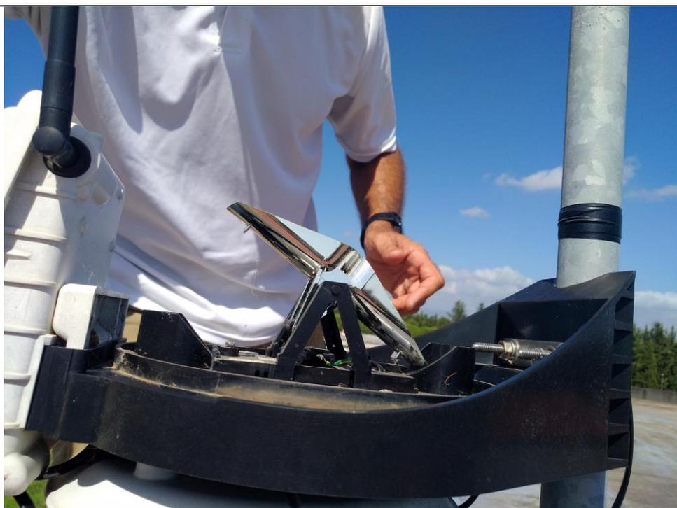
**Pulizia interna del pluviometro dell'unità esterna (ISS)**
