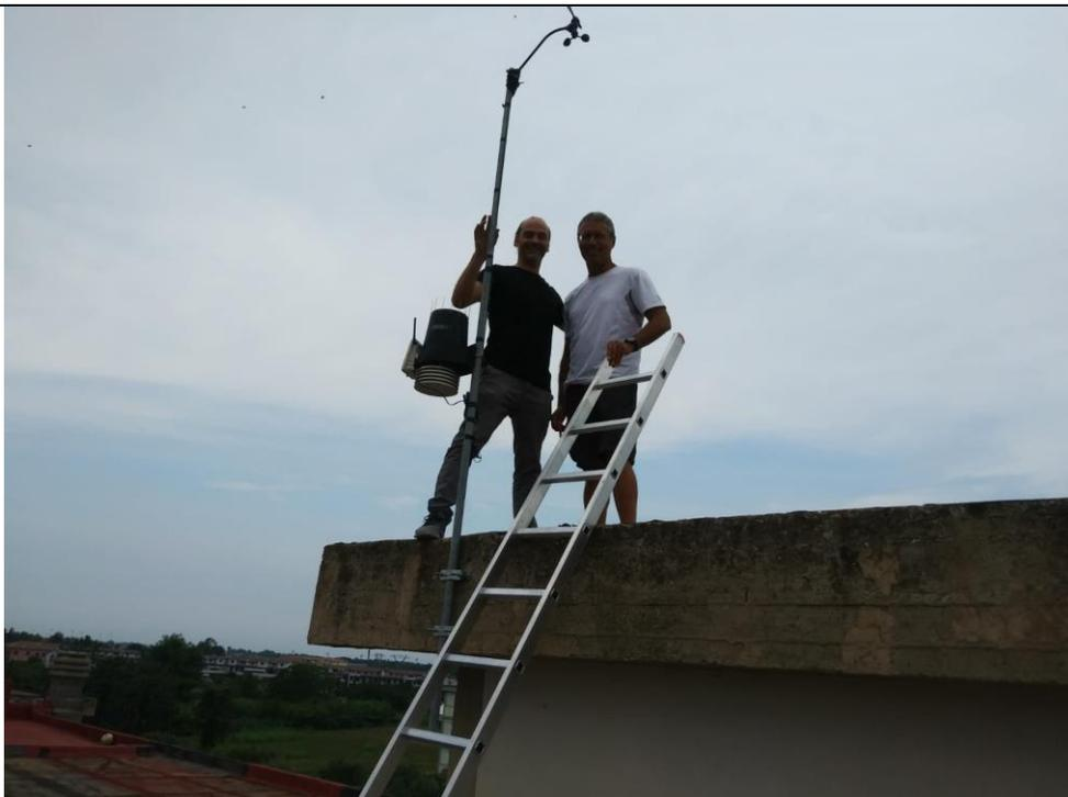
**Uno degli interventi di manutenzione e pulizia dell'unità esterna (ISS) con termo igrometro, barometro, (protetti da schermo passivo Davis) anemometro, pluviometro che comunica con la consolle interna via radio**
